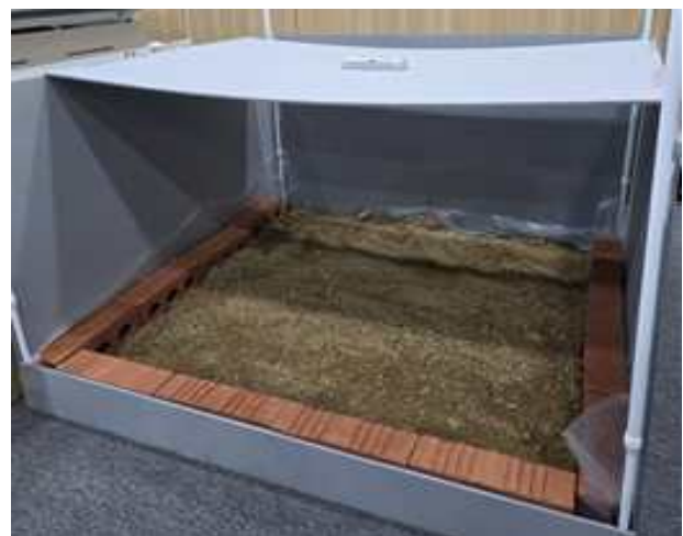
그림 3. 깊이 센싱 기반 굴착 실험을 위한 축소형 샌드박스 환경 Fig. 3. Scaled sandbox environment for depth-sensing-based excavation experiments
