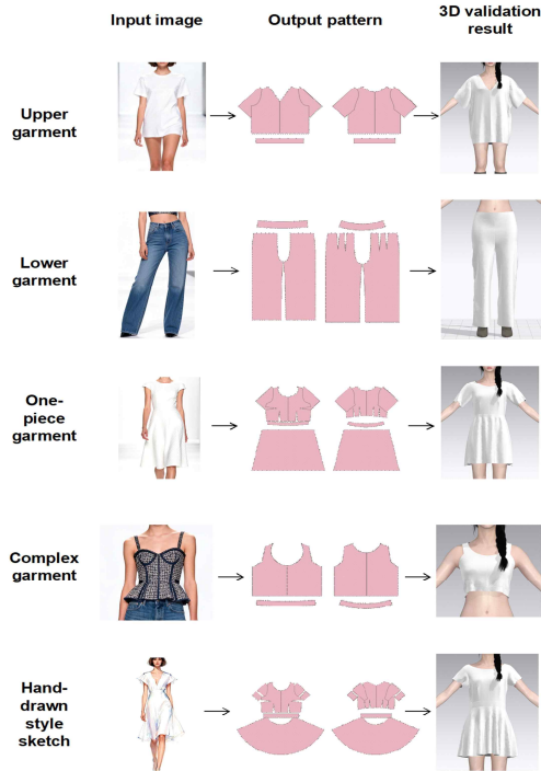
그림 8. CLO3D에서의 패턴 검증 결과 Fig. 8. Pattern validation results in CLO3D
