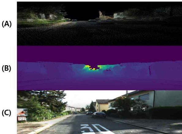
그림 1. (a) 점군데이터 정밀 지도, (b) 가우시안 정밀 지도 기반 깊이 렌더링, (c) 가우시안 정밀 지도 기반 시각적 렌더링 Fig. 1. (a) Point clouds map, (b) Gaussian map based depth rendering, (c) Gaussian map based visual rendering
