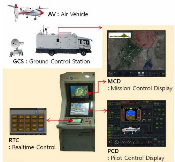
그림 1. 무인항공시스템의 구성, 스마트무인기, 항공우주연구원[2]
