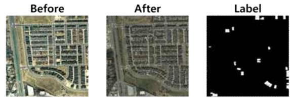
그림 2. Before, After, Label 쌍으로 이루어진 LEVIR-CD Dataset
