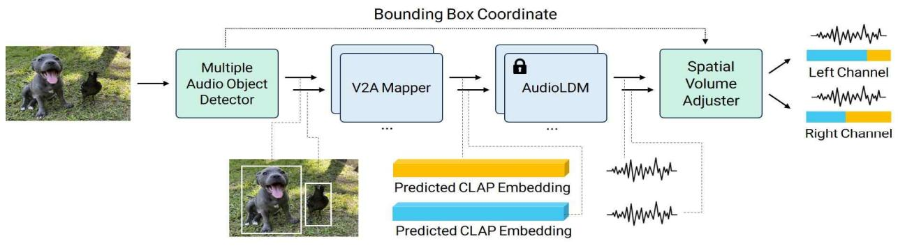
그림 3. 다중 음원 객체 이미지 기반 다중 음원 오디오 생성 시스템 구조도
