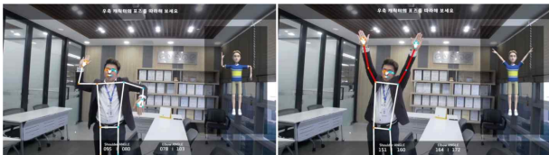
그림 4. open CV 중 하나인 Mediapipe Pose를 이용한 관절 인식 테스트
