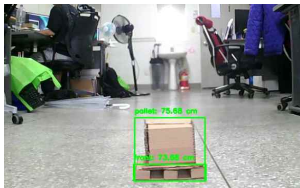
그림 7. 팔레트 거리 측정 시연
