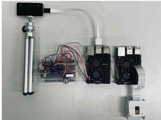
그림 4. 센서 클러스터 구성
