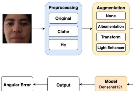
그림 3. 이미지 전처리 및 증강을 통한 DenseNet121 모델 기반 시선 추적 파이프라인
