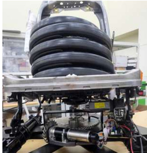
그림 8. 스윙블 시트 실험 사진(75 kg) Fig. 8. Swivel seat experiment picture(75 kg)
