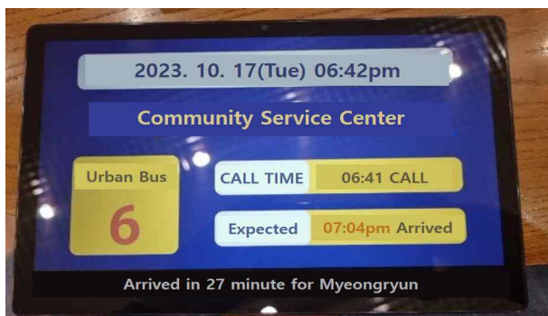
그림 6. 고령자용 정류장 단말 화면 컨텐트(대기, 호출, 도착) 구성 Fig. 6. Terminal screen content for elderly bus stops (waiting, calling, arrival)
