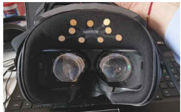
그림 2. 바이브에 부착한 룩시드 링크 Fig. 2. Looxid Link attached to Vive
