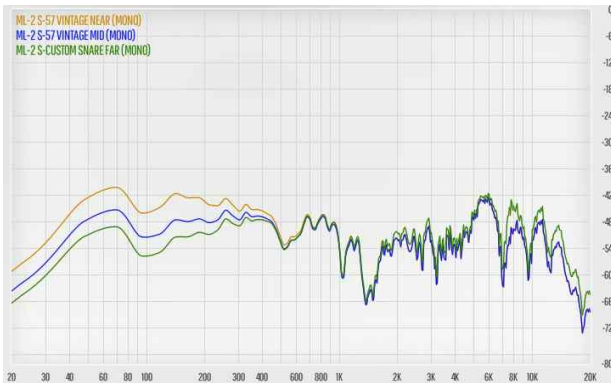
그림 6. ML-2 마이크로폰으로 녹음 후 S-57 Vintage 플러그인을 삽입하고 파라미터를 조정한 화이트 노이즈 녹음본 스펙트럼
