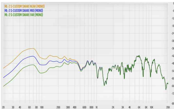
그림 7. ML-2 마이크로폰으로 녹음 후 S-Custom Snare 플러그인을 삽입하고 파라미터를 조정한 화이트 노이즈 녹음본 스펙트럼
