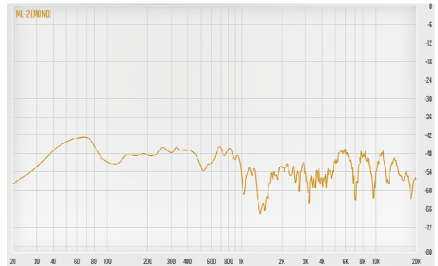
그림 4. ML-2 마이크론으로 녹음한 화이트 노이즈 스펙트럼
