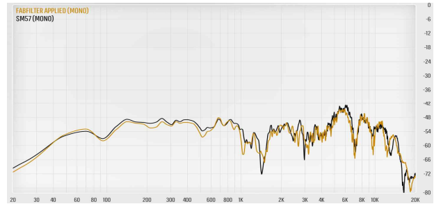
그림 18. 이퀄라이저를 적용한 비교군 최종 후보와 대조군 마이크로폰으로 녹음한 화이트 노이즈 스펙트럼
