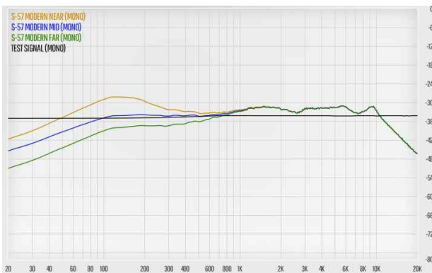
그림 3. S-57 Modern 플러그인을 삽입하고 파라미터를 조정한 화이트 노이즈 스펙트럼
