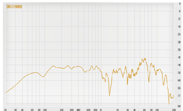
그림 5. SM57 마이크론으로 녹음한 화이트 노이즈 스펙트럼
