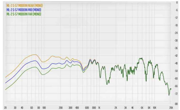
그림 8. ML-2 마이크로폰으로 녹음 후 S-57 Modern 플러그인을 삽입하고 파라미터를 조정한 화이트 노이즈 녹음본 스펙트럼
