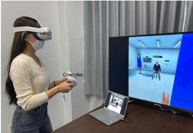
**그림 2.** 가상현실 기반의 머리 착용 디스플레이와 컨트롤러를 이용한 등각촬영법 시뮬레이터 작동 과정에서 보이는 화면
