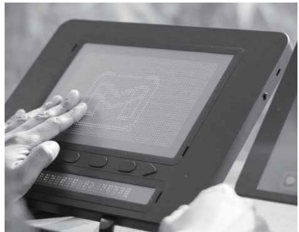
그림 1. 웹 기반 디지털 촉각그래픽 저작 소프트웨어 ‘닷 캔버스’와 점형 기반 출력기기 ‘닷패드’의 인터페이스 Fig. 1. Drawing software ‘Dot Canvas’ and Braille-dot-based refreshable device ‘Dot Pad’ for digital tactile graphic
