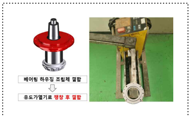
그림 11. 베어링 외륜 조립 과정
