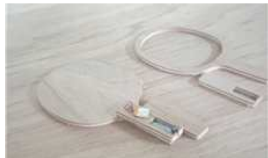
그림 9. 라켓 자이로센서 구조 Fig. 9. Racket gyro sensor structure
