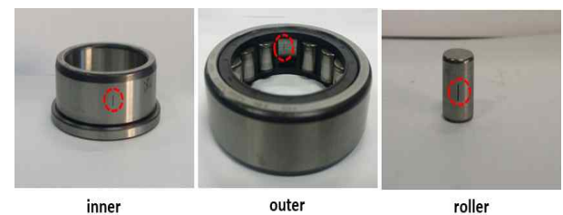
그림 3. 베어링에 발생하는 균열 종류 Fig. 3. Types of cracks occurring in bearings
