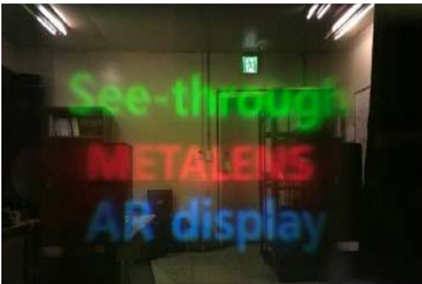
그림 2. 메타 렌즈를 적용한 AR 디스플레이(출처: 이건열 등, 2018) Fig. 2. AR display with meta-lens (Source: Gun-Yeal Lee et al., 2018)
