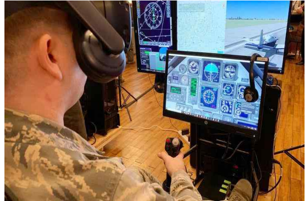
그림 2. 미 공군의 조종사 입문 과정 저비용 훈련시스템 Fig. 2. U.S. Air Force pilot entry course low cost training system
