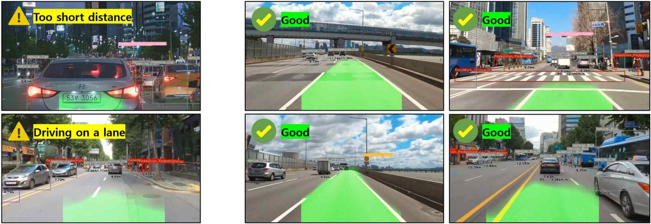
그림 7. (좌) 차간 거리 미유지, 차선 이탈로 인한 감점 (우) 감점되지 않은 경우
