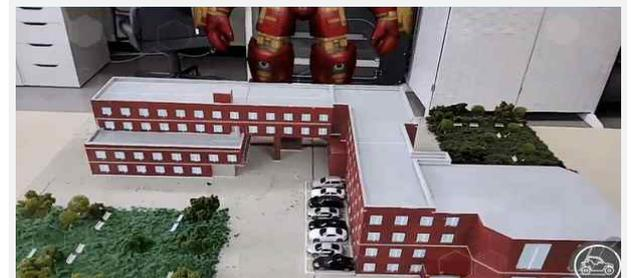
그림 5. 뷰포리아 엔진의 모델 타겟 트래킹을 이용한 메인 건물의 3D트래킹 (위: 3D트래킹을 시도하기 위해 3D모델의 가이드 라인을 화면에 시각화한 모습, 아래: 3D트래킹이 완료되어 가상 물체가 증강된 모습)
