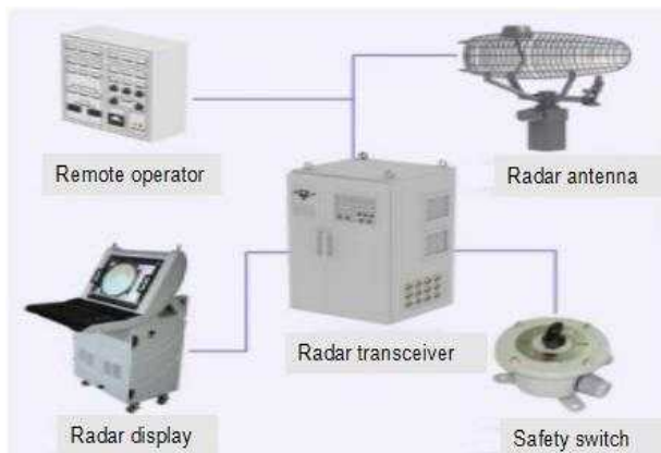
그림 1. 함정용 대함레이더 세트(SPS-95K) 구성
