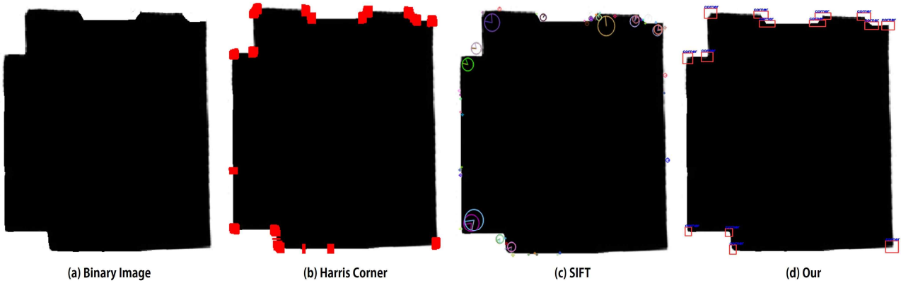
그림 6. 코너 탐지 결과 비교: (a) 바이너리 이미지, (b) Harris Corner, (c) SIFT, (d) CNN 기반 탐지 Fig. 6. Corner Detection Results Comparison: (a) Binary Image, (b) Harris Corner, (c) SIFT, (d) CNN-based Detection
