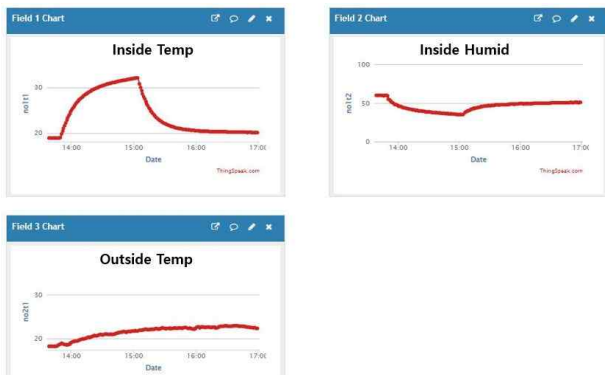
그림 18. PID 제어 시의 온도 변화 Fig. 18. Temperature change during PID control operation
