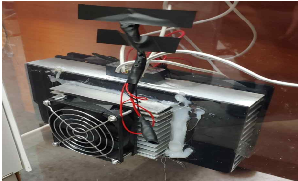
그림 10. 벽에 삽입한 펠티어 모듈 Fig. 10. Peltier module attached to the wall
