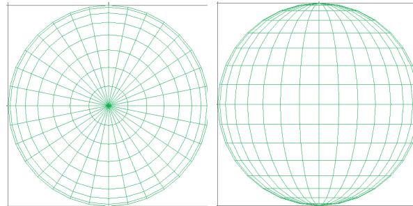
그림 10. S-Octree로 균일하게 구성한 격자. XY 평면에서 바라본 극(pole) 영역(왼쪽)과 ZX 평면에서 본 적도(equator) 영역
