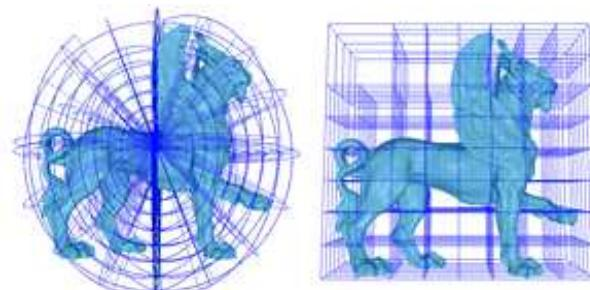
그림 2. 구면좌표계에서 정의된 octree(왼쪽, “S-Octree”)와 일반적인 직교좌표계에서 정의된 octree(오른쪽, “C-Octree”)
