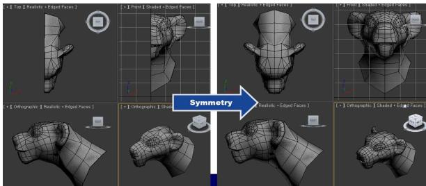
그림 3. 3dsMAX에서 Symmetry modifier를 이용해서 절반만 제작한 메시 모델을 대칭 복제해서 캐릭터를 완성하는 과정
