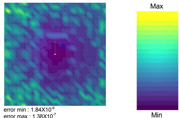
그림 7. XY 평면( $Z=0$ )에 위치한 직사각형 평면 메시의 각 꼭지점 좌표에 대해 직교좌표와 구면좌표의 연속 변환(직교좌표 → 구면좌표 → 직교좌표) 과정에서 발생하는 L2 오류(평균 제곱근 편차). 빨간색/녹색/파란색 화살표는 직교 좌표의 x축, y축, z축을 의미하며 z축은 보이지 않는 상태.
