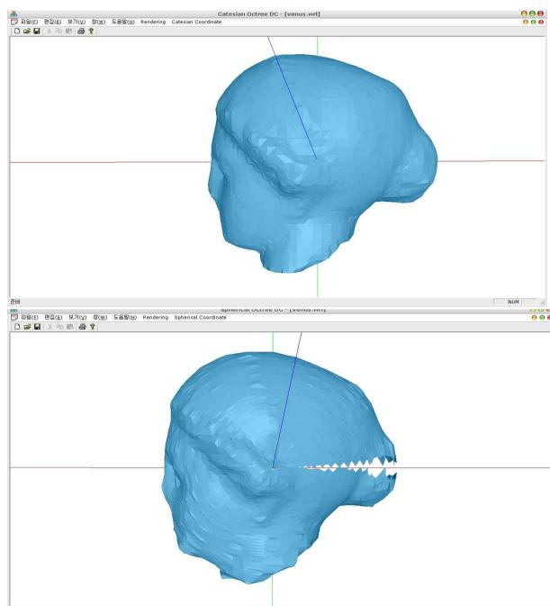
그림 5. 직교좌표계에서의 octree 기반 폴리곤 메시(위)와 구면좌표계에서의 octree 기반 폴리곤 메시(아래)
