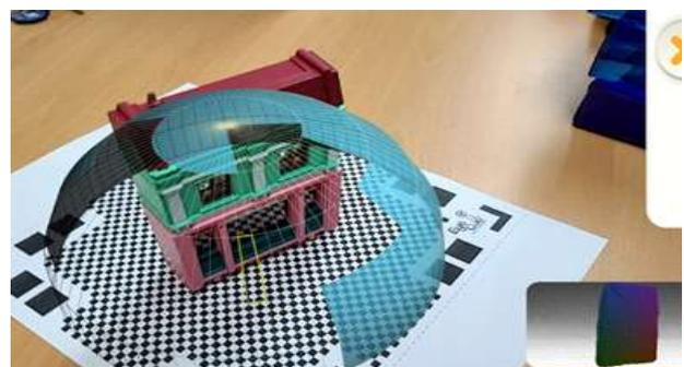
그림 5. Qclone을 이용해 실제사물을 3D 모델로 스캔하는 모습
