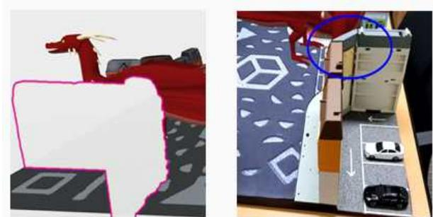
그림 7. 마스크 기능을 이용하여 가상물체가 현실물체에 가려짐을 구현
