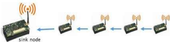
그림 12. 무선 센서 네트워크의 선형 토폴로지 Fig. 12. Linear Topology of Wireless Sensor Network
