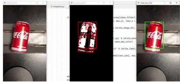
그림 4. 자체 제작한 HSV 색상값 기반 자동 라벨링 SW Fig. 4. Automatic labeling SW based on HSV color model
