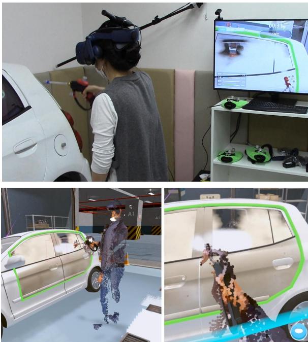
그림 15. 가상 스팀 세차(상) 및 훈련 콘텐츠(하) Fig. 15. Virtual steam wash(top) and training content(bottom)
