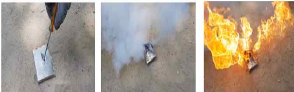
그림 10. 리튬배터리 정중앙관통실험 Fig. 10. Lithium Battery Perforation Test
