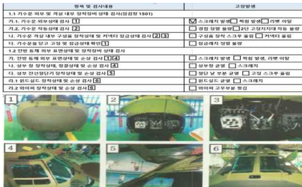
그림 7. 일일정비 점검 항목 설정 화면 구성 Fig. 7. Preventive Maintenance Daily(PMD) check item setting screen
