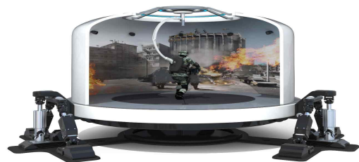
그림 5. 확장현실(XR) 전투기술훈련체계 개념도 Fig. 5. The Concept of XR Combat Skill Training System
