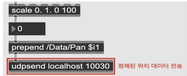
그림 4. 정제된 위치 데이터 전송 모습
