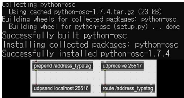
그림 3. 파이선과 Max/MSP의 OSC통신 기능 설치 Fig. 3. Installing OSC protocol on Max/MSP and Python
