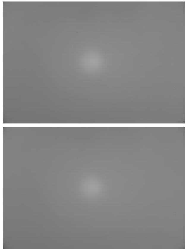
그림 10. 카본블랙 페인트를 칠하지 않은 렌즈(상), 칠한 렌즈(하)의 촬영 결과
