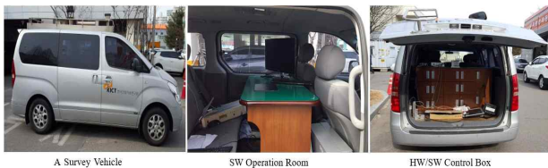
그림 5. TMS를 설치한 조사차량 Fig. 5. TMS installed in the survey vehicle
