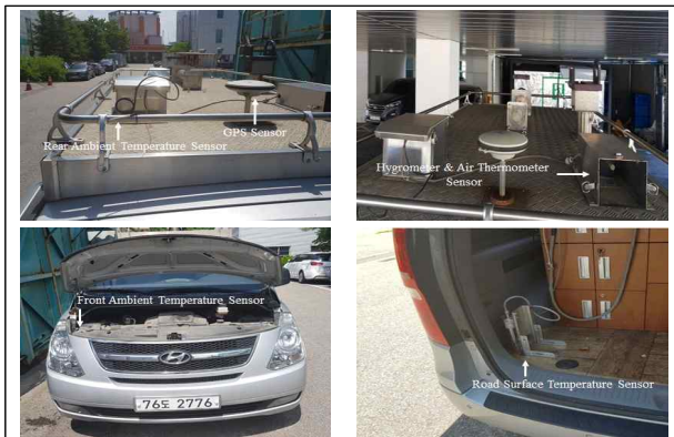
그림 6. 자료수집을 위한 센서들의 설치 위치 Fig. 6. Location of each sensor on the survey vehicle
