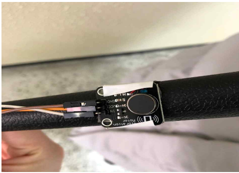
그림 11. 손잡이에 부착한 DM159 진동 모듈 Fig. 11. DM159 Vibration Module Attached to the Smart Cane Handle
