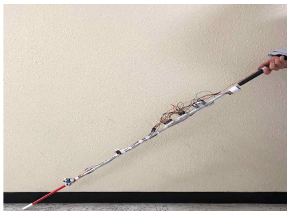
그림 6. 제안하는 초음파 센서 기반 스마트 지팡이
