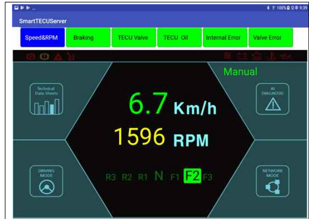
그림 7. CAN를 통한 지게차 속도, RPM 및 기어상태 표시 Fig. 7. CAN based Forklift Speed, RPM & Gear State
