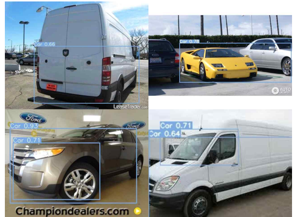
그림 13. 페어런트 모델이 차일드 데이터 셋 영상에서 객체 영역을 잘 못 추론한 예 Fig. 13. Examples of parent model inferring object region from child data set image incorrectly
