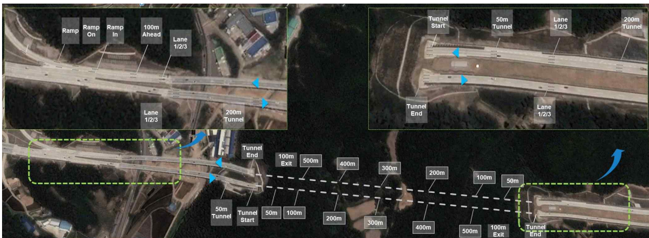
그림 9. DLS 코드의 고속도로 활용 예시 Fig. 9. Application example in expressway, ramp and tunnel
