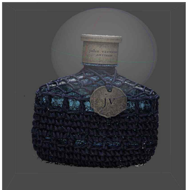
그림 20. 향수 3D 모델 점 구름 생성과정 Fig. 20. Perfume 3D model point-cloud generating process
