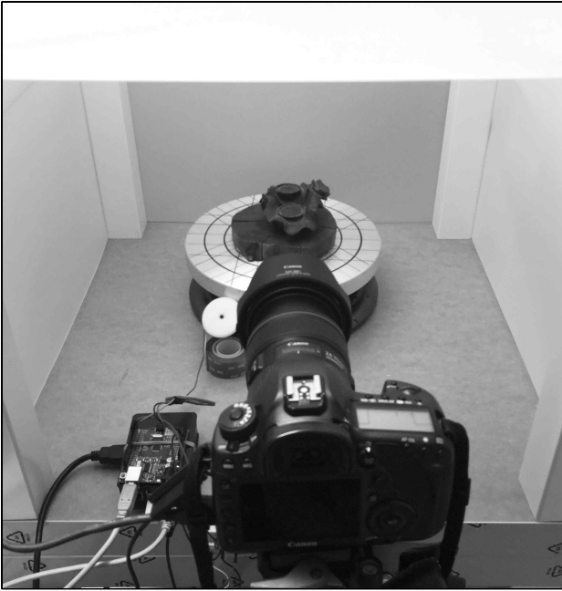
그림 9. 3D 모델링을 위한 자동촬영시스템 Fig. 9. Automatic photogrammetric system for 3D modeling
