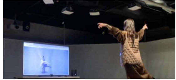
그림 2. TransMotion을 사용하고 있는 실험 참여자. 스크린에는 사용자가 취한 포즈로부터 시작하는 발레 동영상 클립이 보여진다.
