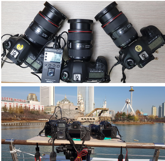
그림 6. 카메라와 인터벌 타이머 릴리즈의 구성 Fig. 6. The configuration of the release of the camera and interval timer
