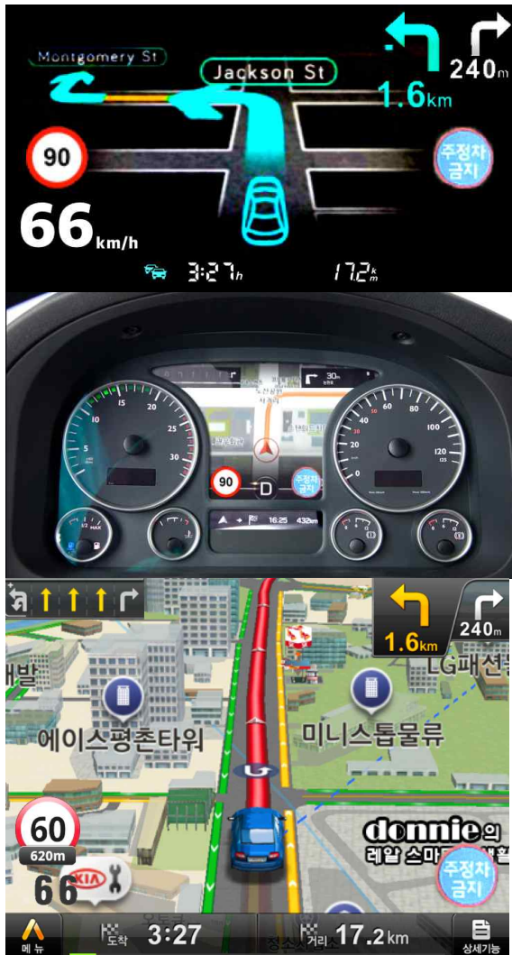
그림 3. 시각적 정보제시 인터페이스 위치와 지원정보의 조합으로 이뤄진 운전자 지원정보 시스템 이미지 (위에서부터 아래로; ①HUD, ②클러스터, ③센터페시아)
