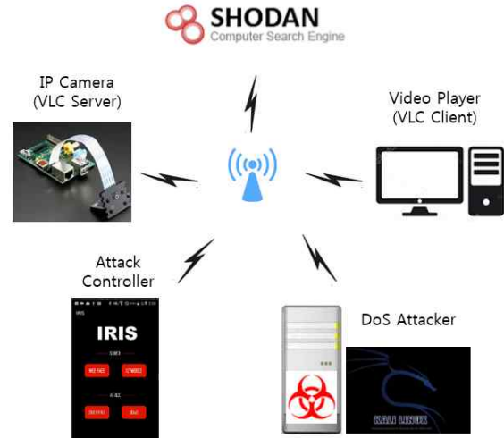
그림 3. 해킹 공격을 위한 시험 구성도 Fig 3. Test Architecture for Hacking Attack
