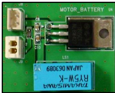
그림 7. 모터부 전원 공급 실제 보드 Fig. 7. Real board of power supply for motor parts
