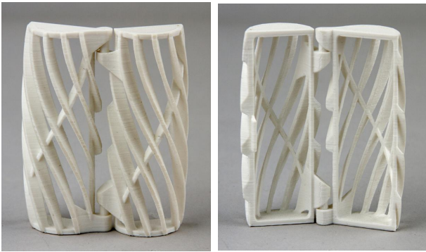
그림 9. 3D 프린팅의 장점을 살리기 위한 프레임 디자인 적용 Fig. 9. Application of frame design to take advantage of 3D printing
