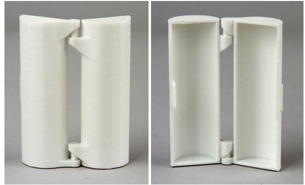
그림 7. FDM 3D 프린터를 사용한 도장케이스의 출력 점검
