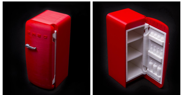
그림 11. 중형 냉장고 미니어처에 비-조립 가동형 경첩을 적용한 3D 모델링과 3D 프린터로 출력한 결과물
