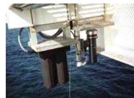
그림 2. KENEK의 해양파고 측정 장치 (UH-401)
